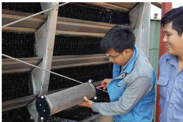
Đặt collector trong tháp giải nhiệt
