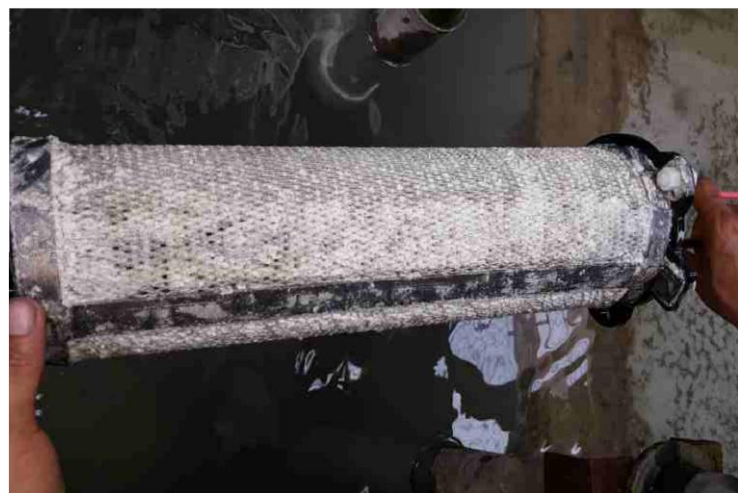
Cấu cặn bám vào collector sau 20 ngày
